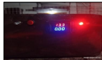
Gambar 8. Tegangan Terbaca Pada Charger Saat Pengisian
