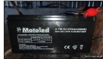
Gambar 7. Spesifikasi Baterai (aki)
