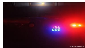
Gambar 9. Charger Memutus Pengisian Pada Baterai
