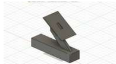
Gambar 10. Desain Dudukan Pedal Rem
