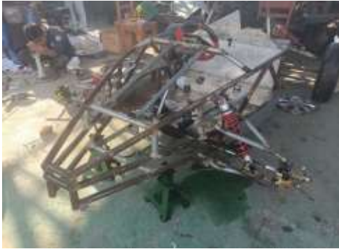
Gambar 12. Hasil Akhir Rancang Bangun Sistem Pengereman Cakram Kendaraan Mobil Listrik
