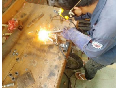
Gambar 19. Pengelasan Pipe Arm Dengan Ball Joint dan Bushing Pipe Arm
