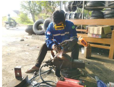
Gambar 20. Pengelasan Knuckle Arm Belakang
